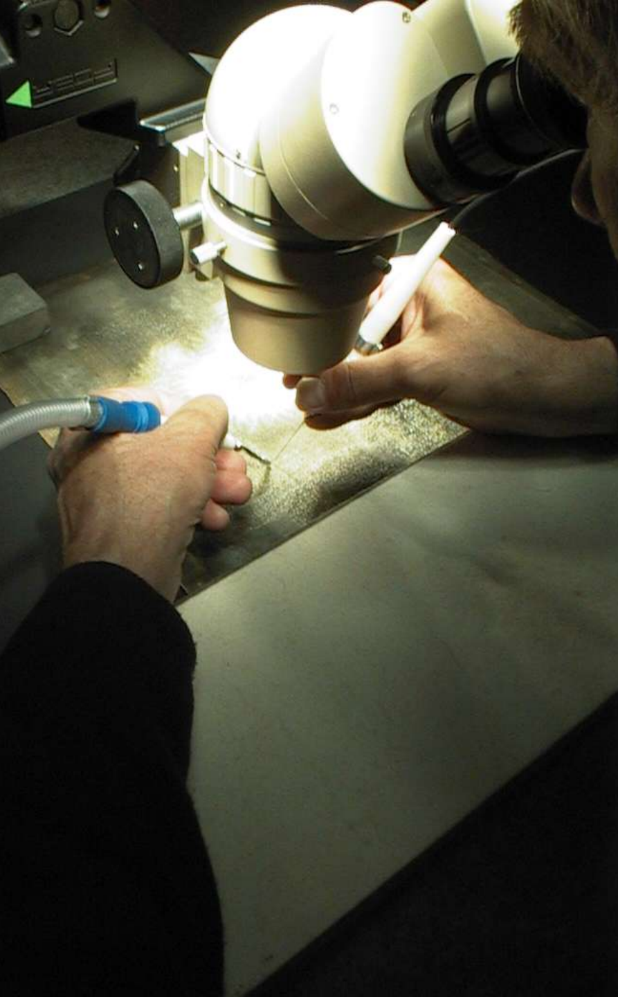
Microjet del solvente ed aspirazione immediata
