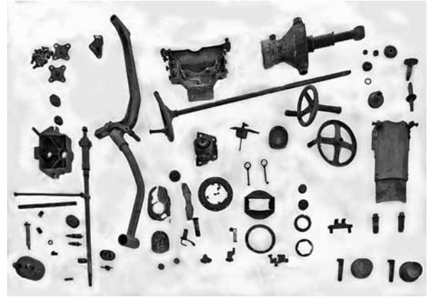
Fig. 14. Componenti del meccanismo di alzo del cannone SKODA 10.4
