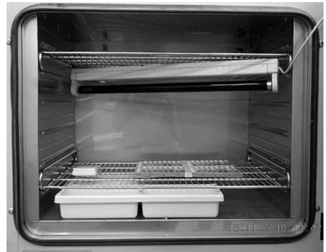
Fig. 10. Camera di invecchiamento allestita all'interno del laboratorio scolastico.
