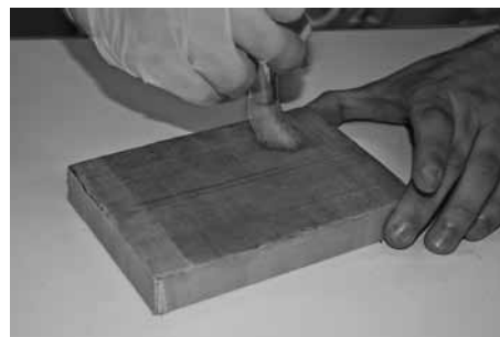
Fig.4. Applicazione a pennello della vernice Regalrez 1094 in Ligroina 100-140°C.
